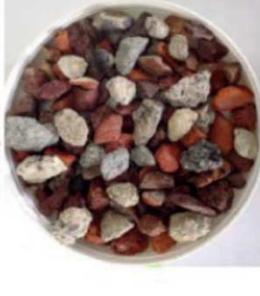
70 % maçonnerie - 30 % béton
