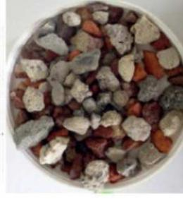
50 % maçonnerie - 50 % béton
