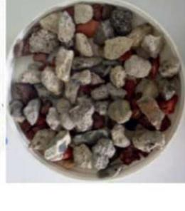
30 % maçonnerie - 70 % béton
