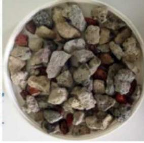
10 % maçonnerie - 90 % béton
