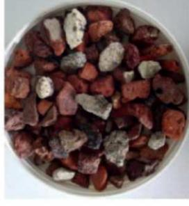
90 % maçonnerie - 10 % béton
