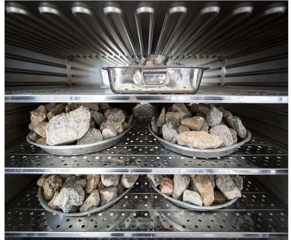
**Figure 6 :** Dispositif de l'essai Micro-Deval en présence d'eau (CRR)
