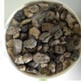
0 % maçonnerie - 100 % béton
