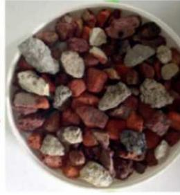
80 % maçonnerie - 20 % béton
