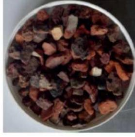
100 % maçonnerie - 0 % béton
